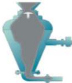
Fermeture de la vanne dans le produit
